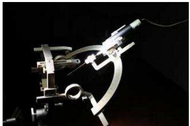
3—Système d'infusion intracérébrale du vecteur viral
